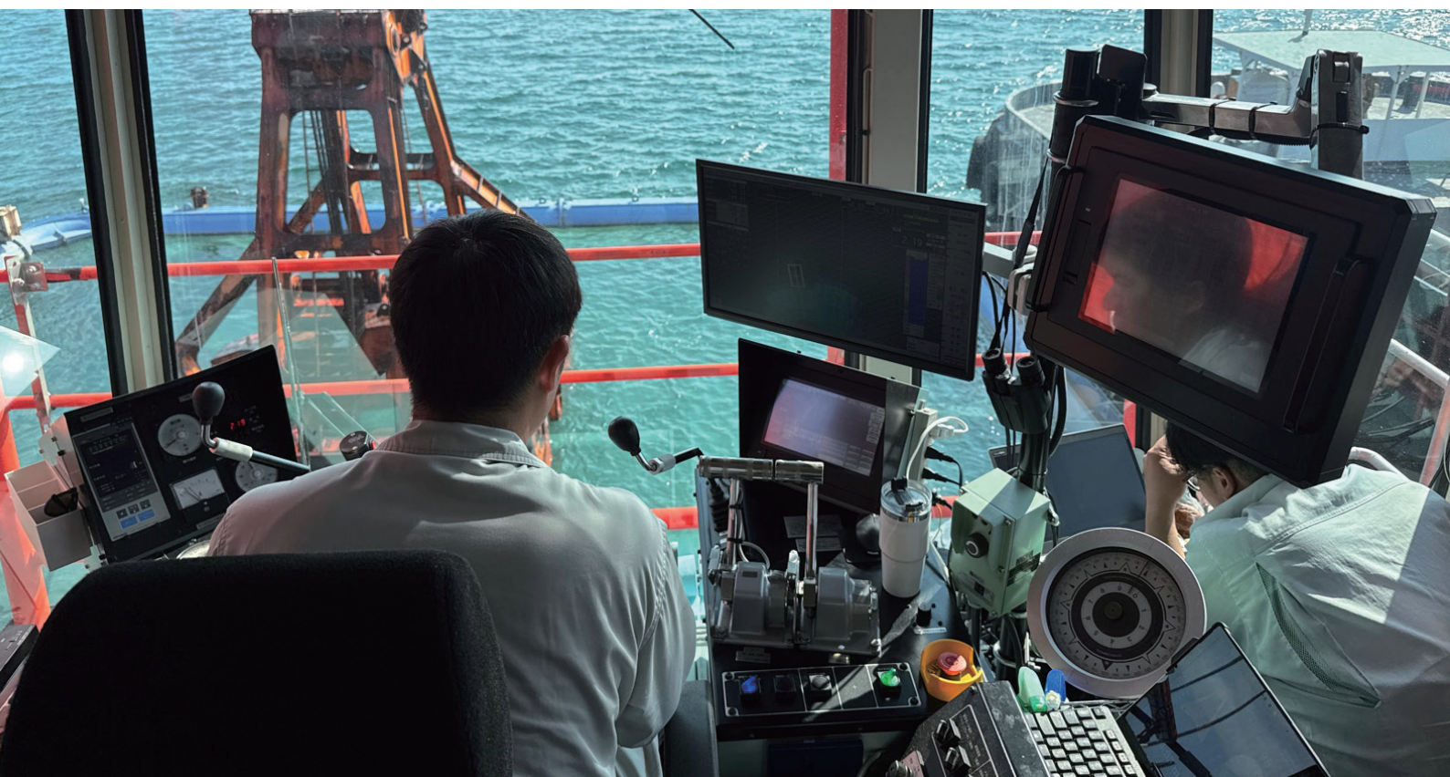
クラムシェル浚渫船における自動運転の実施状況
