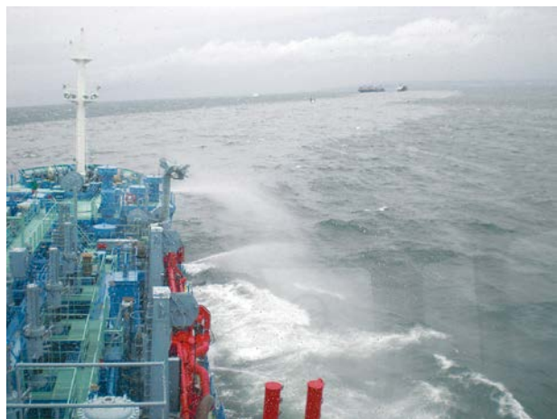
写真-1 「白山」による航走及び放水拡散作業の様子
