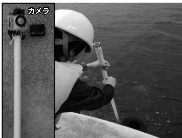
図-6 水中カメラによる外板（喫水上部）の点検状況
