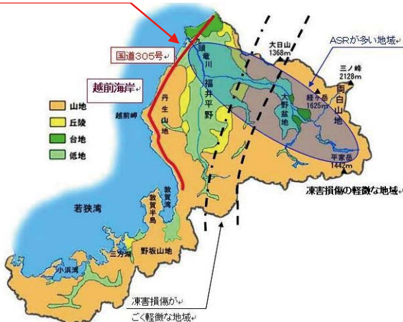
図-1 ASRや塩害、凍害による損傷発生が多い地域
