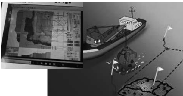
図-3 捨石投入効率化のイメージ
