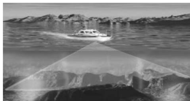
図-1 マルチビーム測定のイメージ
