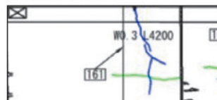
図-3 赤外線画像による浮き検出箇所
