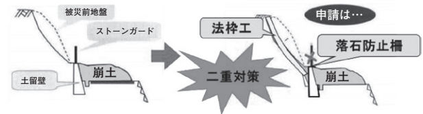
図-3 法面对策として、法枠工+落石防止柵を申請(二重対策と判断される事例)
