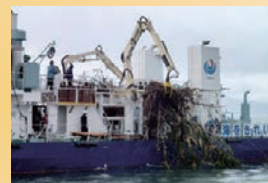
多関節クレーンによる回収
