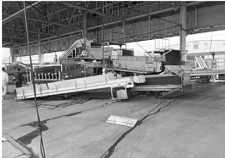
写真-2 静岡県焼津市・焼津漁港荷さばき所ベルトコンベヤ損壊
