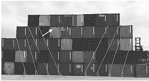
写真-5 コンテナ固縛事例
