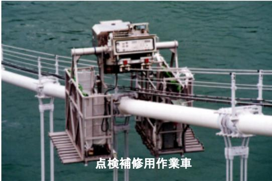
点検補修用作業車
