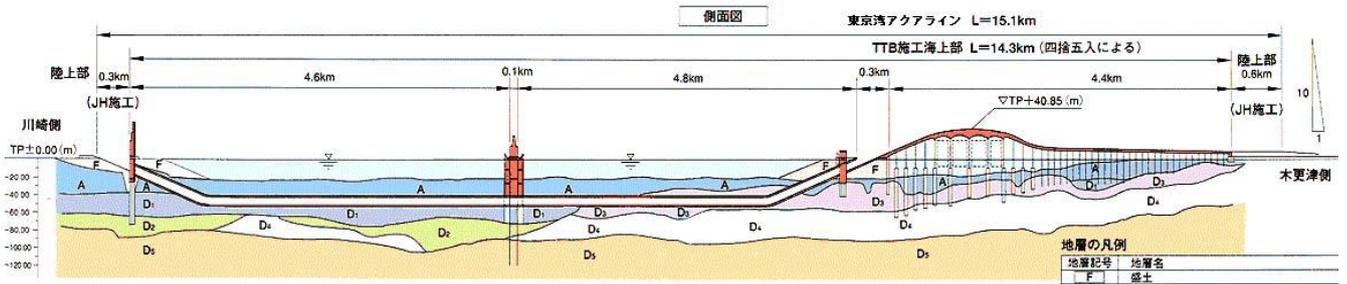
シールドトンネルは、外径が約 14m もある世界最大級のシールドマシン（掘削機械）で掘削したトンネル。最大の難工事とされたトンネルは、東京湾の水面下約 60m を掘削するには、軟弱地盤と高水圧との戦いであった。海底道路トンネルとしては、世界最長のもの。
