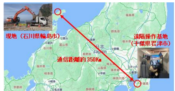
県外からの遠隔施工
