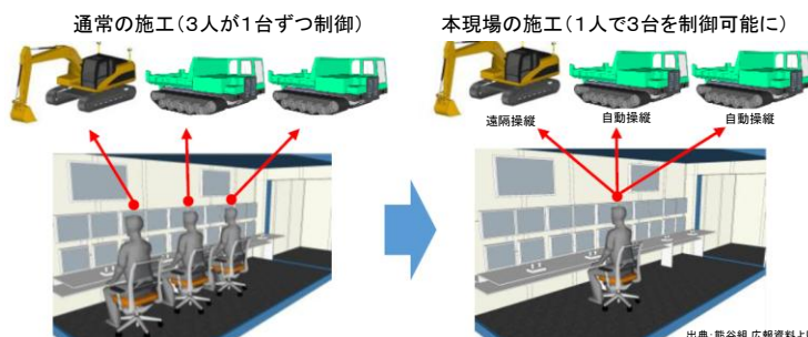
通常の遠隔施工より少人数で重機を操縦
