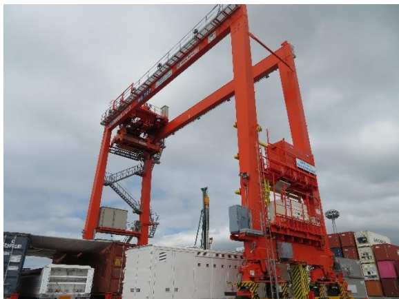
水素エンジン発電機換装 RTG の全景
