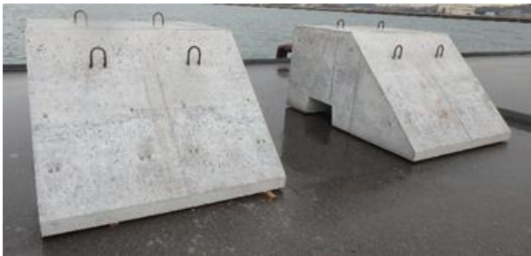
図-3 製作した水和固化体ブロック(代表例)
