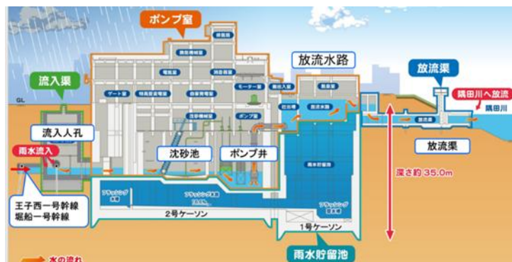
図-2 王子第二ポンプ所断面図
