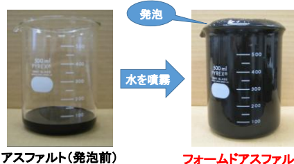
写真-1 通常のアスファルトとフォームドアスファルト
