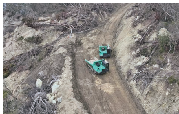
自動操縦による不整地運搬車のすれ違い
