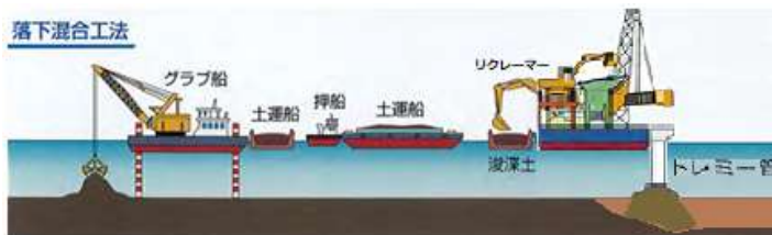
図-8 落下混合工法(トレミー管投入)
