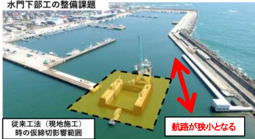
従来工法で施工した場合の状況(想定)
