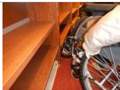
モックアップによるユニバーサルデザイン検証の様子 (右)車椅子のフットレストと書棚が干渉することを確認し、巾木の高さを検討
