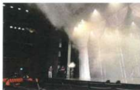
演出用スモークを用いた気流の可視化
