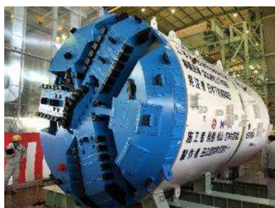
工事で使用したシールドマシン
