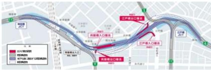
図-1 日本橋区間地下化事業 平面図
