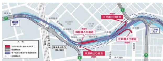
江戸橋・呉服橋出入口撤去位置
