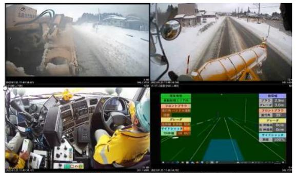
ドライブレコーダで取得したオペレータ操作情報
