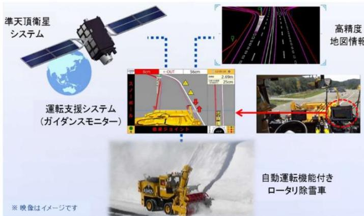
※準天頂衛星システム「みちびき」からの信号とあらかじめ作製した高精度地図情報を組み合わせることで、車両の正確な位置を運転席のモニターに3D地図画像で表示し、除雪作業を支援するシステムです。
