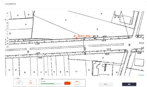
道路占用管理システムで台帳付図を呼び出し、位置図を作成
