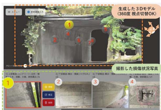
3Dモデルを活用した損傷写真の撮影箇所図イメージ
