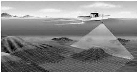
図-2 マルチビームによる水深測量
