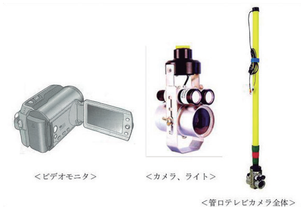
写真-1 管口カメラ
