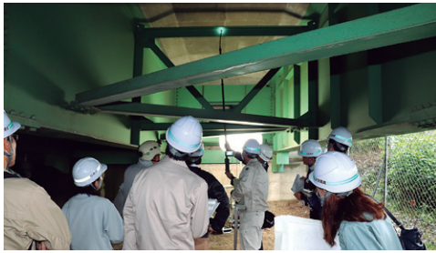
写真-1 参加者を4班に分けて実施した実機（ボールカメラ）を用いた試行の状況
