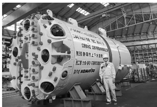
工事で使用したシールドマシン
