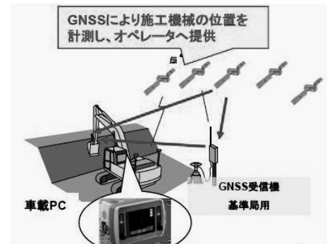
図-4 GNSSによるバックホウガイダンスイメージ
