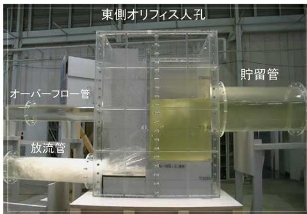
流量制御施設の水利模型実験状況
