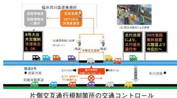
片側交互通行規制箇所の交通コントロール
