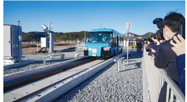
阿波海南駅モードインターチェンジの様子
