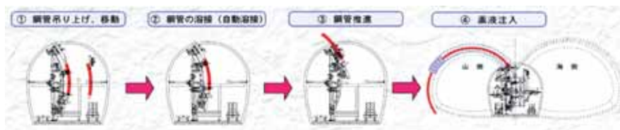
PSS-Arch工法施工手順
